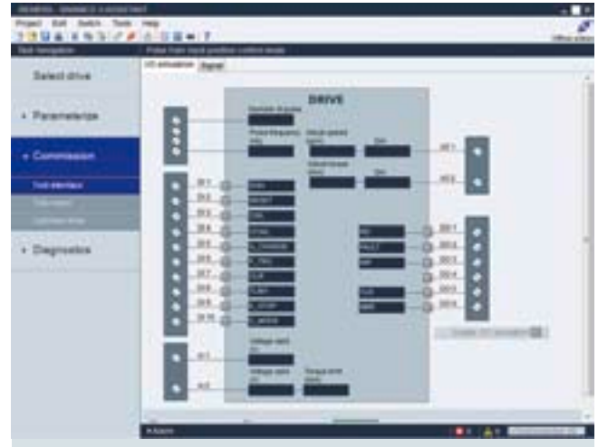
提供图形化的界面，用户直观地监测数字量输入 / 输出和其他控制信号的状态
